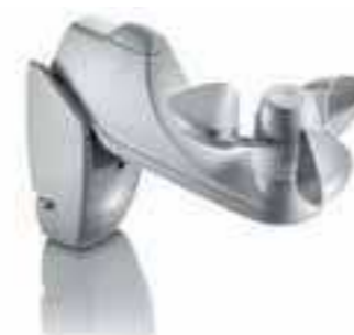
Windsensor zum Schutz einer oder mehrerer Jalousien. Erkennt die Windgeschwindigkeit und schließt die Jalousie(n), wenn der Wind den voreingestellten Grenzwert überschreitet. Lieferung mit 5m Kabel. LED zur unmittelbaren Anzeige der korrekten Stromversorgung. Stromversorgung 230V. FSEOLISRTS
